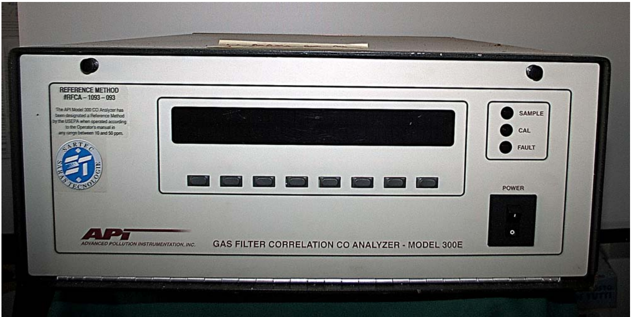
Analizzatore di CO API 300E
