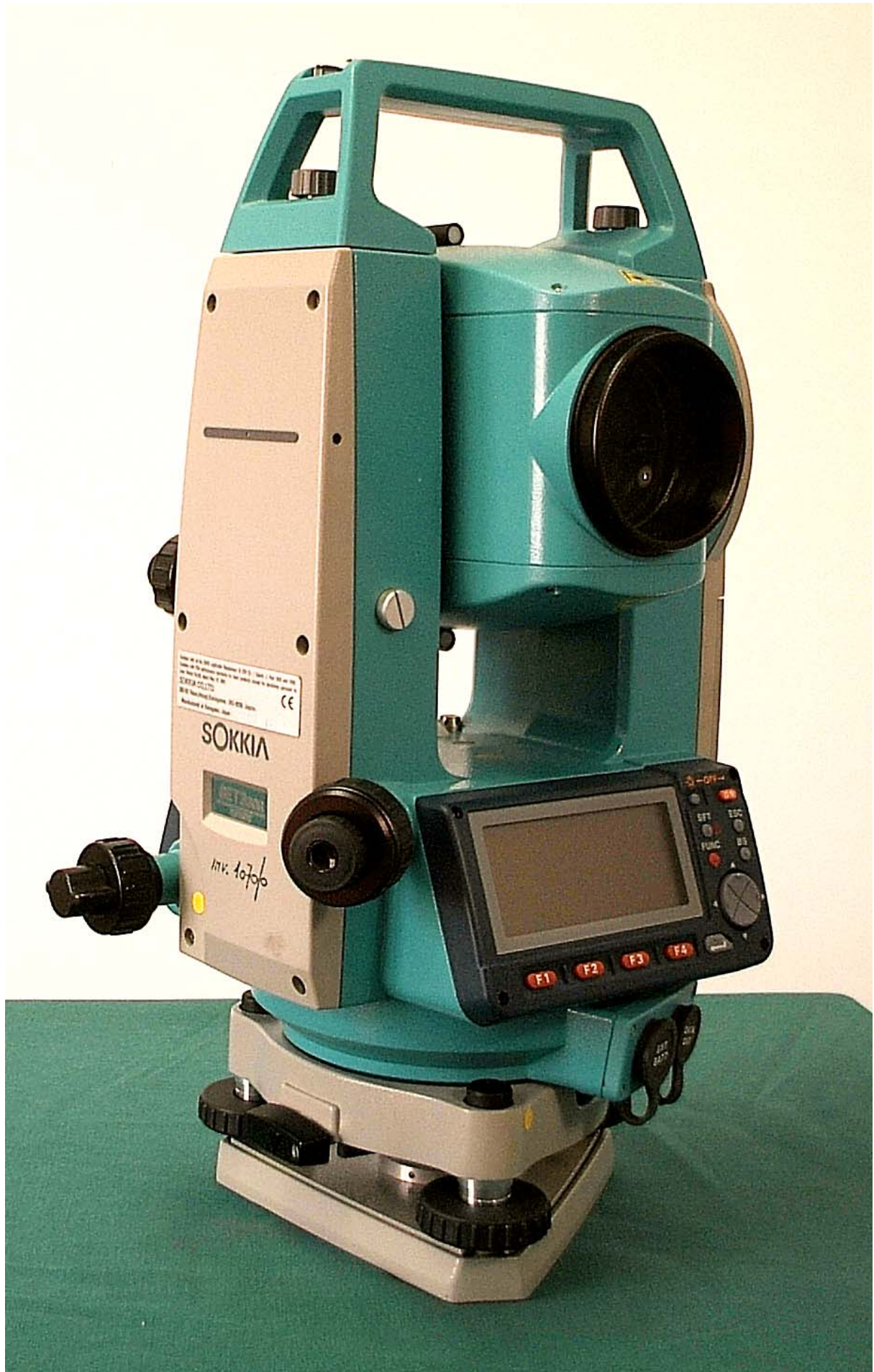
N° inventario 1070/0 – Stazione totale senza prisma Sokkia SET 300R (2002)
