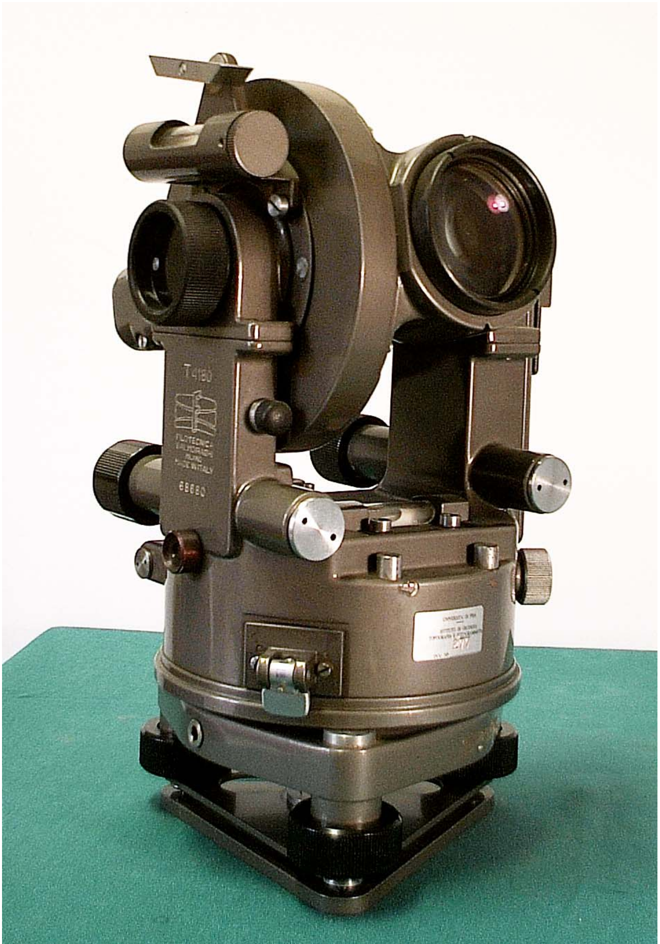
N° inventario 277 – Tacheometro autoriduttore Salmoiraghi mod. 4180 matr. 68680 (1957)
