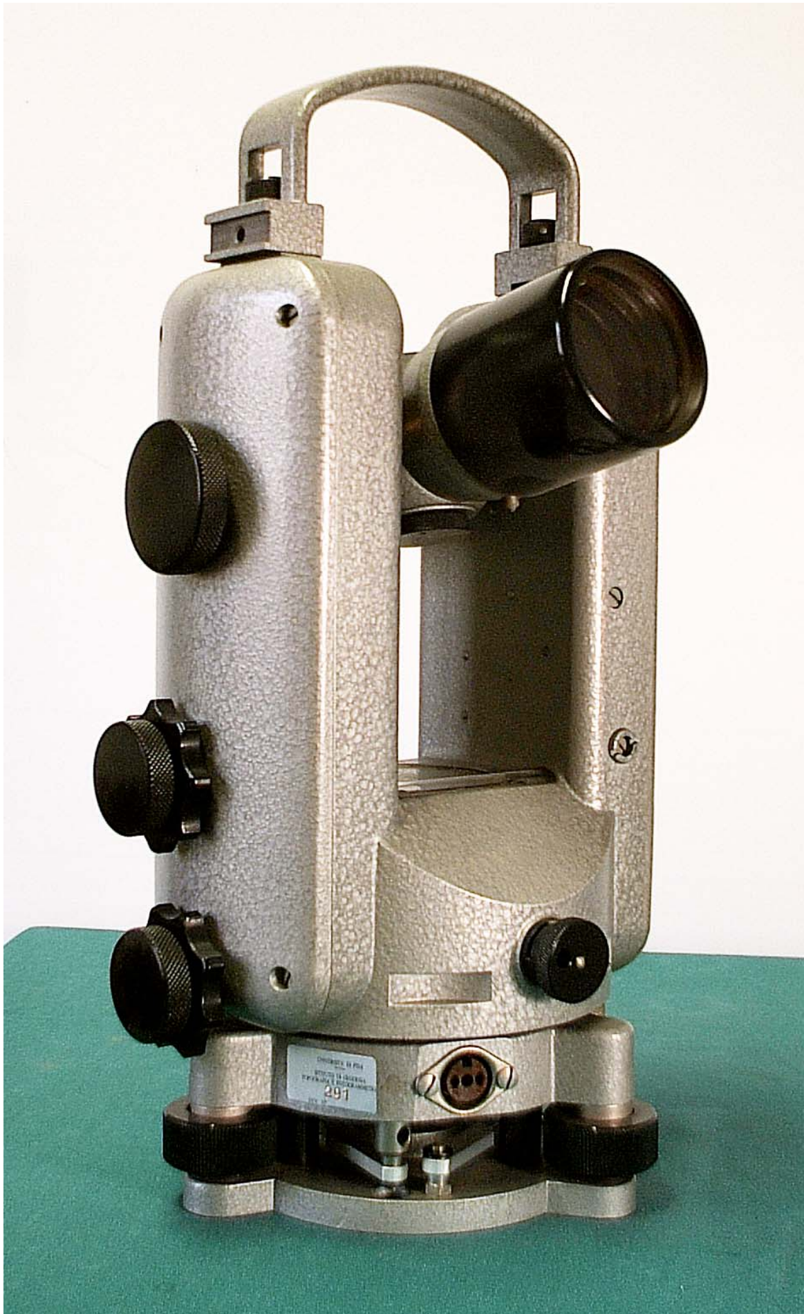
N° inventario 291 – Teodolite Askania mod. TU a 1" matr. 580837 (1958)
