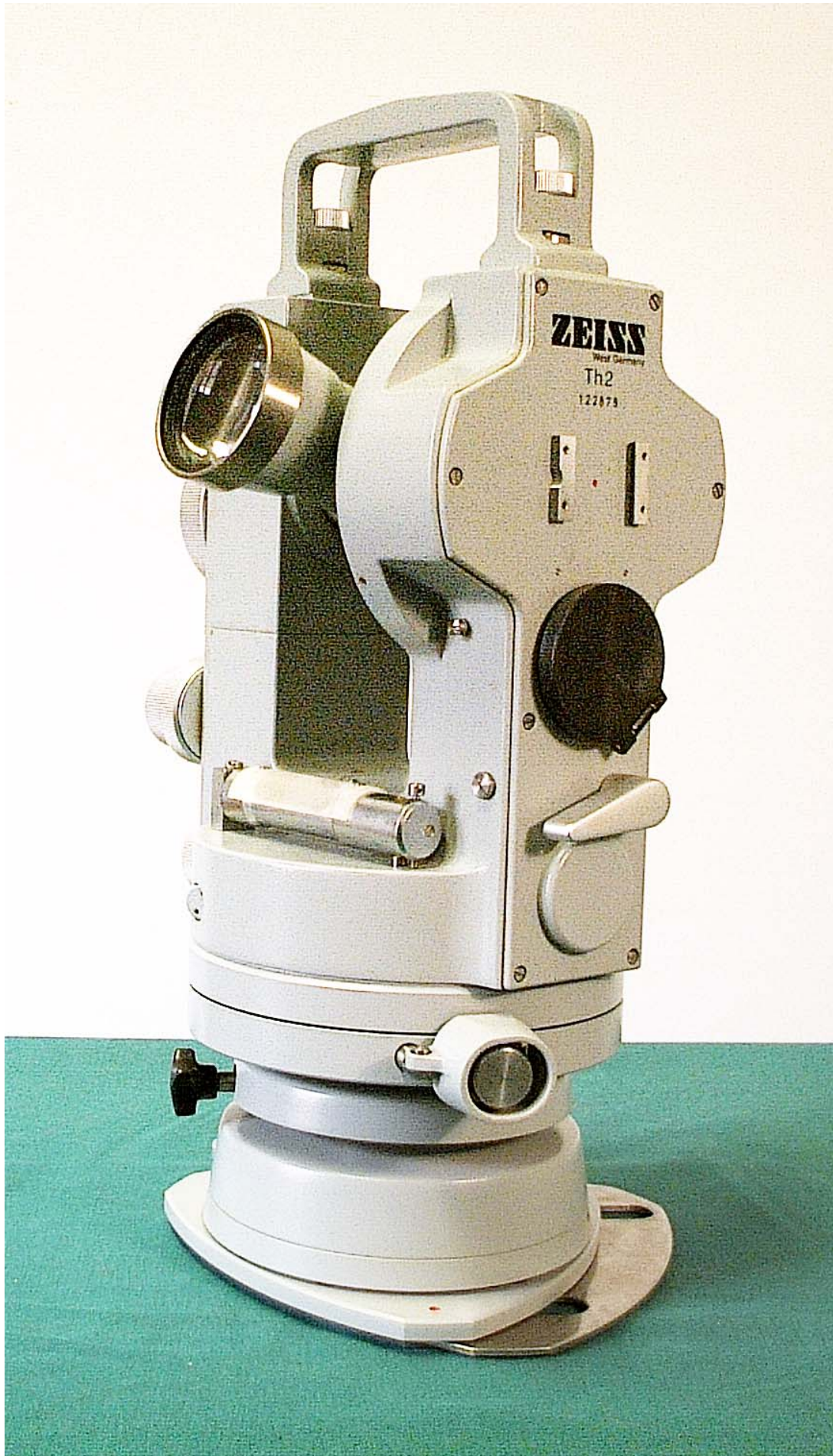
N° inventario CNR 385603 – Teodolite Zeiss Th2
