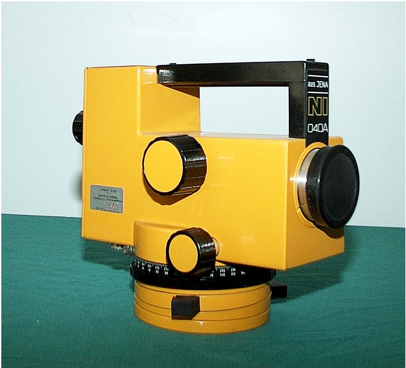
N° inventario 669 – Autolivello aus Jena mod. Ni 040A matr. 012345 (1988)
