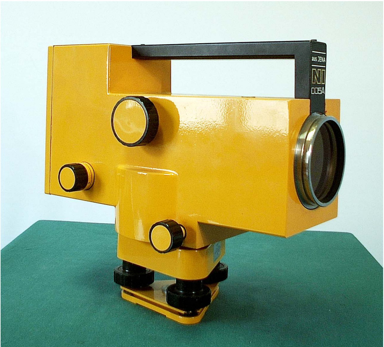
N° inventario 669 – Autolivello aus Jena mod. Ni 005A matr. 001165 (1989)
