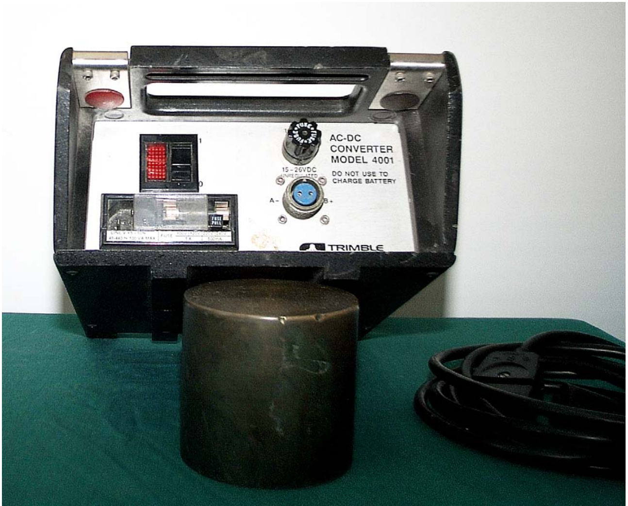
N° inventario 757 – Convertitore AC/DC per ricevitore GPS Trimble 4000 SL (1991)
