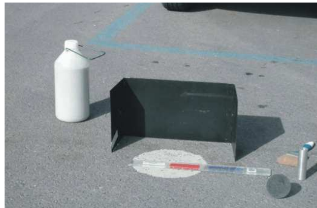
Attrezzatura per la misura della macro-rugosità superficiale
