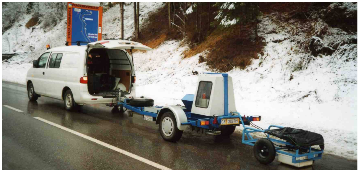
Utilizzo combinato di FWD per i rilievi di deflessione e GPR per i rilievi di spessore
