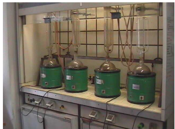
Apparecchiatura per l'estrazione del legante dal conglomerato bituminoso
