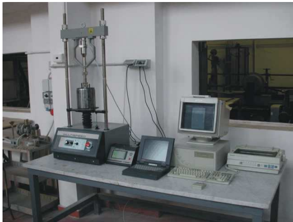
Pressa multispeed per prove di portanza C.B.R. sulle terre, sugli aggregati e su loro miscele con leganti
