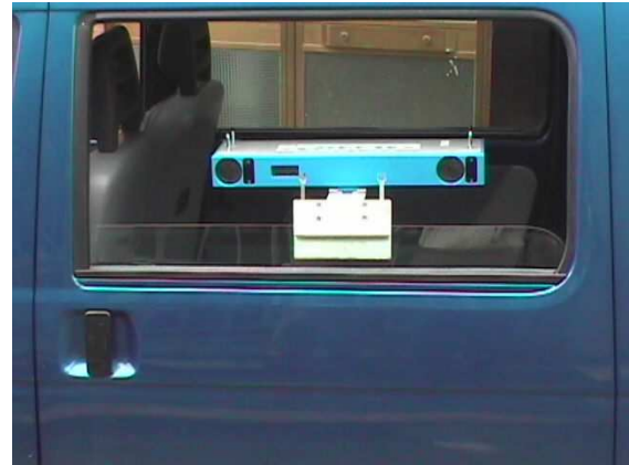
Rilevatore di velocità a raggi laser
