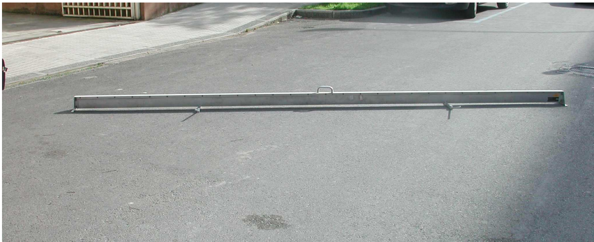
Trave di riferimento MOT per il rilievo delle irregolarità superficiali
