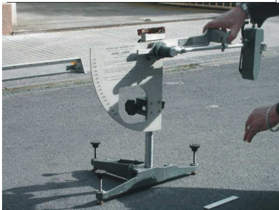
British Skid Resistance Tester per la misura dell'attrito radente
