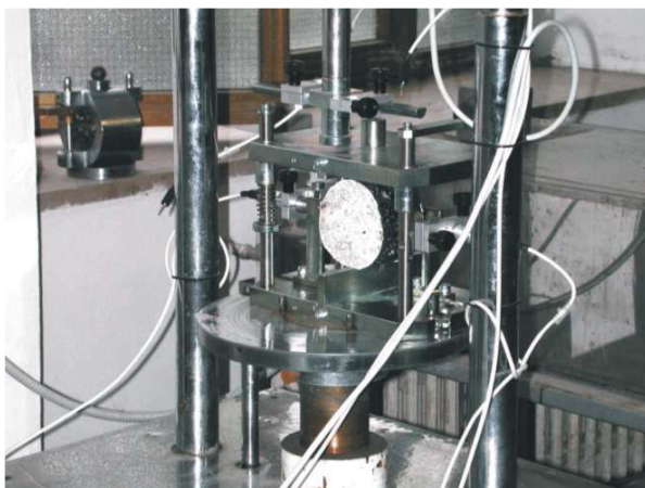
Particolare della testa di carico per la prova di trazione indiretta
