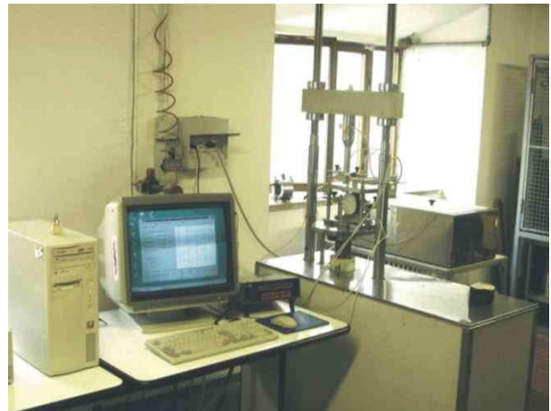
Apparecchiatura Marshall per la caratterizzazione dei conglomerati bituminosi
