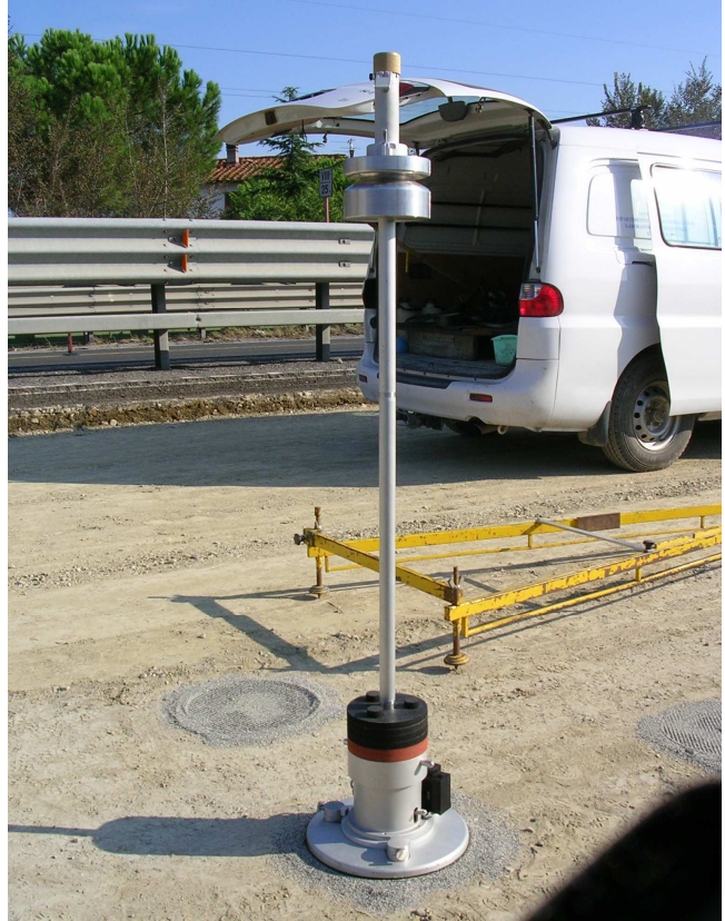
Prove di carico con piastra dinamica Dynatest LWD
