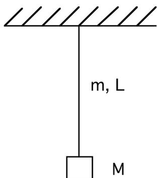
Una corda di massa  $m$  e lunghezza  $L$  tiene appesa ad un soffitto una massa  $M$ . La massa  $M$  viene leggermente percossa da un piccolo impulso orizzontale. Si calcoli il tempo necessario perchè la perturbazione così indotta sulla corda si propaghi fino al soffitto.
