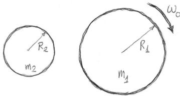
Due cilindri, aventi rispettivamente raggi  $R_1$  ed  $R_2$  e masse  $m_1$  ed  $m_2$ , sono sostenuti da assi di rotazione meccanici perpendicolari al piano della figura. Il cilindro grande ruota inizialmente con velocità angolare  $\omega_0$ , mentre quello piccolo viene spostato verso destra finché, giunto a contatto con quello grande, inizia a ruotare per attrito. Cessata la fase di slittamento i due cilindri ruotano con velocità
