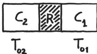
Due parallelepipedi metallici, aventi capacità termiche rispettivamente  $C_1$  e  $C_2$  sono collegati da un corpo che è un debole conduttore termico avente resistenza termica  $R$ . Per  $t=0$  le temperature dei corpi sono  $T_{01}$  e  $T_{02}$  con  $T_{01} < T_{02}$ . Si chiede di calcolare la temperatura  $T_2$  del parallelepipedo a sinistra in funzione del tempo per  $t > 0$ .
