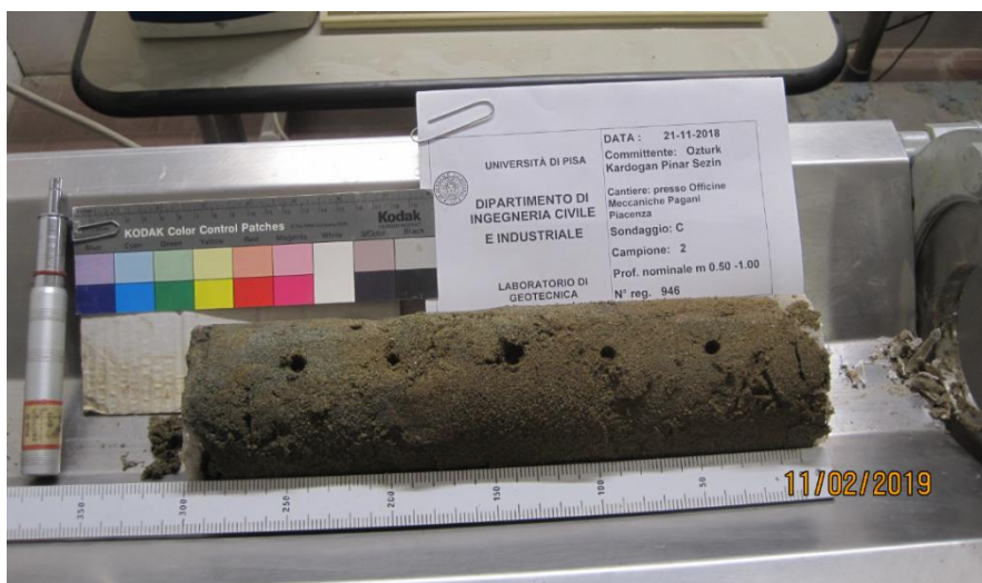
Figura 7. Campione estruso con tavola di Munsell e penetrometro
