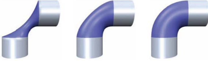
Figura 4: Esempi diversi, tutti validi, di superficie più liscia possibile [7].
