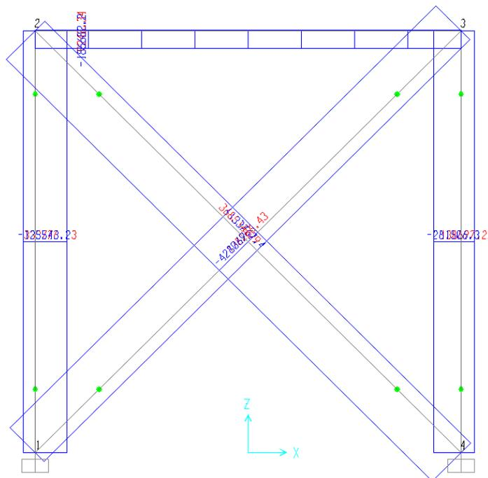
**Involuppo della forza normale nelle aste ( $N_{\min} = -428.1$  kN,  $N_{\max} = 368.5$  kN)**
