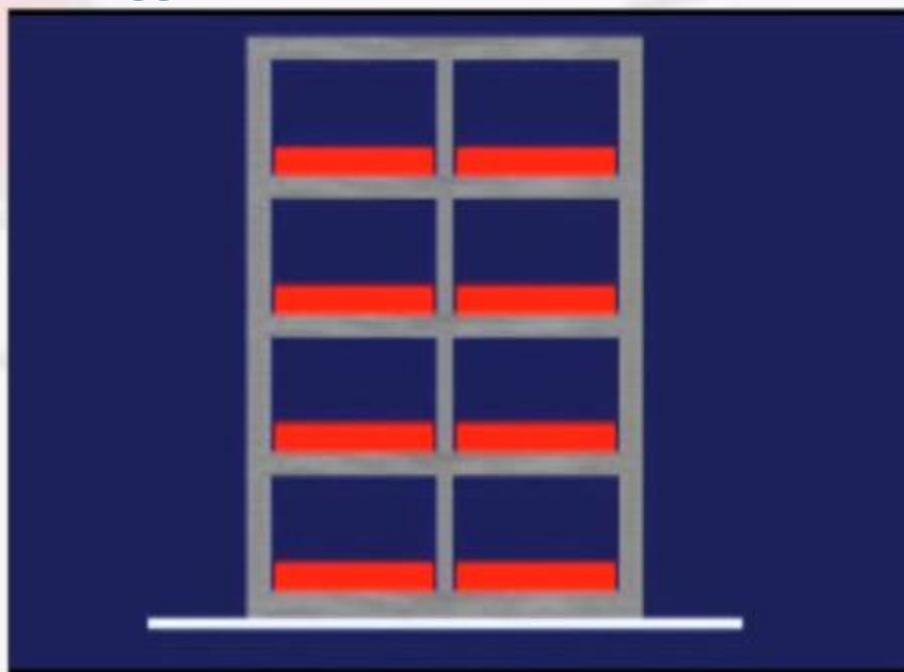
La frequenza di oscillazione della struttura (costruzione) diminuisce all'aumentare della massa dell'edificio
