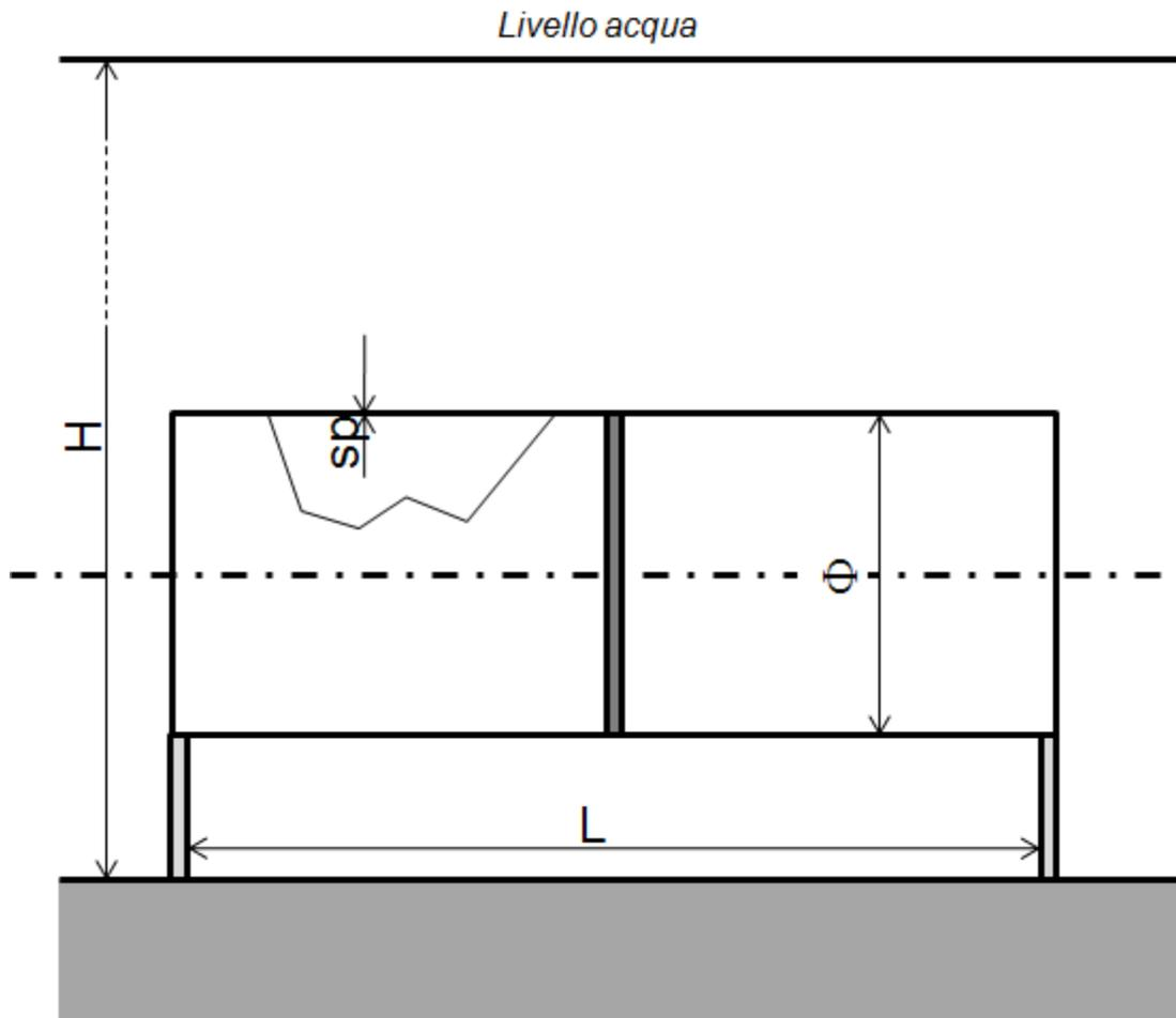
$$L_0 := 5 \cdot \text{m} \quad s_p := 1 \cdot \text{mm} \quad \Phi := 2 \cdot \text{m} \quad H_0 := 20 \cdot \text{m}$$
