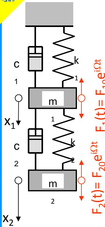
$$\begin{bmatrix} k_1 + k_2 + i\Omega(c_1 + c_2) - \Omega^2 m_1 & -k_2 - i\Omega c_2 \\ -k_2 - i\Omega c_2 & k_2 + i\Omega c_2 - \Omega^2 m_2 \end{bmatrix} \begin{Bmatrix} X_1 \\ X_2 \end{Bmatrix} = \begin{Bmatrix} F_1 \\ F_2 \end{Bmatrix}$$
