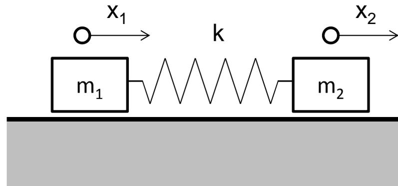
$$-\omega^2 \begin{bmatrix} m_1 & 0 \\ 0 & m_2 \end{bmatrix} \begin{Bmatrix} X_1 \\ X_2 \end{Bmatrix} e^{i\omega t} + \begin{bmatrix} k & -k \\ -k & k \end{bmatrix} \begin{Bmatrix} X_1 \\ X_2 \end{Bmatrix} e^{i\omega t} = 0$$
