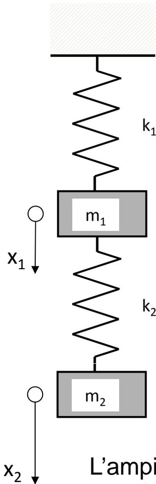
Sostituendo una delle due pulsazioni proprie nelle equazioni di equilibrio dinamico si ottiene un sistema di due equazioni dalle quali ricavare quale ricavare  $X_1$  ed  $X_2$ .
