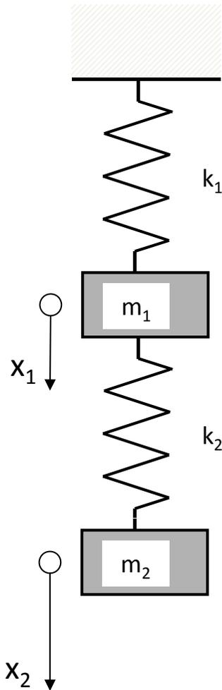
$$-\omega^2 \begin{bmatrix} m_1 & 0 \\ 0 & m_2 \end{bmatrix} \begin{Bmatrix} X_1 \\ X_2 \end{Bmatrix} e^{i\omega t} + \begin{bmatrix} k_1 + k_2 & -k_2 \\ -k_2 & k_2 \end{bmatrix} \begin{Bmatrix} X_1 \\ X_2 \end{Bmatrix} e^{i\omega t} = 0$$
