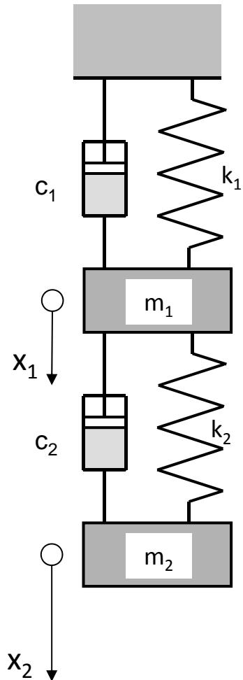
$$\begin{bmatrix} m_1 & 0 \\ 0 & m_2 \end{bmatrix} \begin{Bmatrix} \ddot{x}_1 \\ \ddot{x}_2 \end{Bmatrix} + \begin{bmatrix} c_1 + c_2 & -c_2 \\ -c_2 & c_2 \end{bmatrix} \begin{Bmatrix} \dot{x}_1 \\ \dot{x}_2 \end{Bmatrix} + \begin{bmatrix} k_1 + k_2 & -k_2 \\ -k_2 & k_2 \end{bmatrix} \begin{Bmatrix} x_1 \\ x_2 \end{Bmatrix} = 0$$
