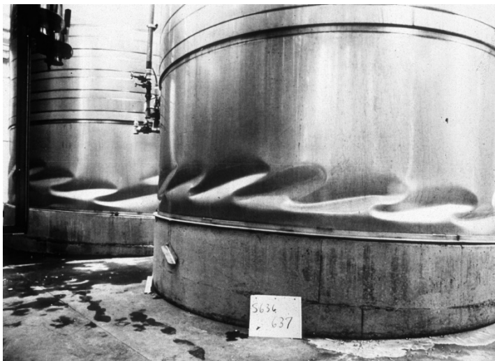
«buckling» da carichi sismici
