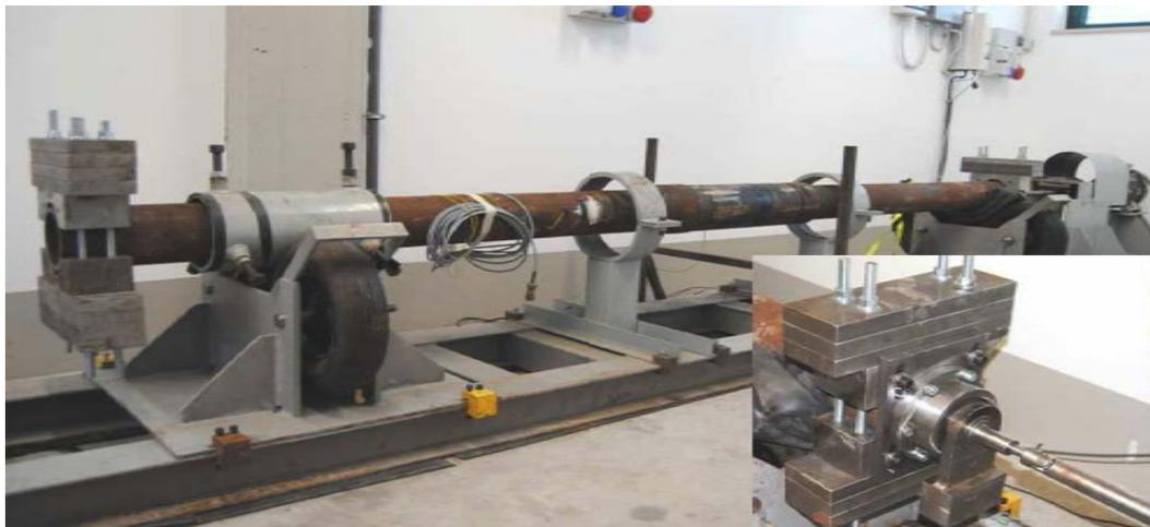
Fig. 1 – Macchina di prova a fatica in piena scala a flessione rotante per Drill Pipes.
