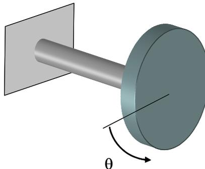
Se si sposta il volano dalla sua posizione di equilibrio imprimendogli una rotazione attorno all'asse della trave, quest'ultima reagirà applicando al volano stesso una coppia di reazione data da:
