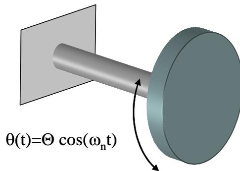
Analogamente al caso del sistema massa-molla, anche in questo caso le oscillazioni sono possibili solo per una particolare pulsazione detta **pulsazione propria (o naturale) torsionale** del sistema.
