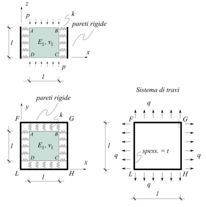
Problema 1. Un elemento cubico, di lato *l*, costituito da un materiale di Lamé, è soggetto a una pressione uniforme applicata sia sulla base superiore che su quella inferiore. Su tutte le facce laterali, l'elemento è vincolato elasticamente ad un contenitore scatolare, le cui pareti possono essere pensate, almeno in prima approssimazione, come perfettamente rigide.
