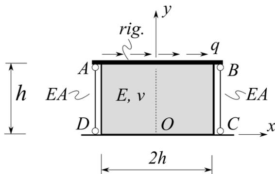
**Problema 1.** L'elemento rettangolare ABCD mostrato in figura, di spessore unitario, è costituito da un materiale elastico di Lamé. In corrispondenza della base superiore AB l'elemento aderisce perfettamente a una trave rigida su cui agisce un carico distribuito, d'intensità uniforme  $q$ ; la base inferiore DC è invece incastrata a un supporto fisso. Inoltre, la trave rigida AB è vincolata alle estremità alle due aste verticali estensibili AD e BC.
