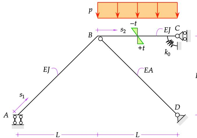
1) Risolvere il problema col metodo delle forze, scegliendo le seguenti due incognite iperstatiche:  $X_1$  pari alla forza normale nell'asta  $BD$  e  $X_2$  uguale alla coppia elastica trasmessa dal vincolo elastico in  $C$ . In particolare:
