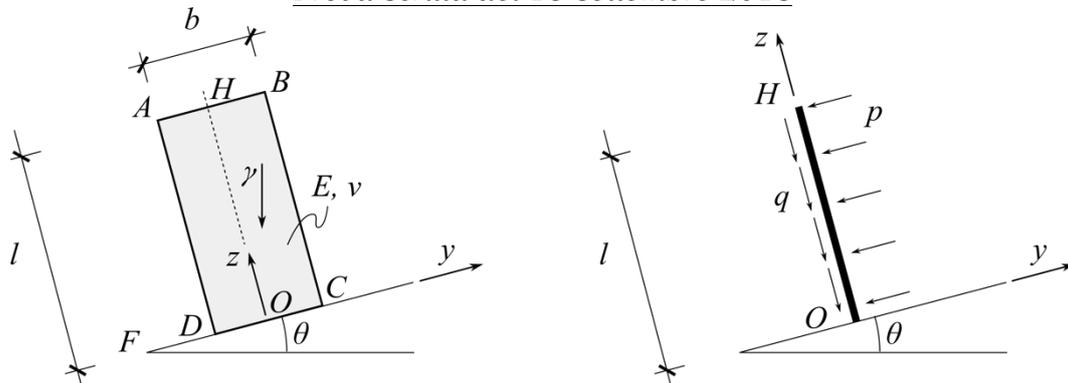
**Problema 1.** Nel problema piano nella tensione mostrato a sinistra nella figura l'elemento ABCD, di lati  $b$  e  $l$  nel piano del disegno e di spessore unitario in direzione ortogonale, è costituito da un materiale di Lamé. L'elemento è perfettamente aderente ad un supporto rigido FDC, inclinato di un angolo  $\theta$  rispetto all'orizzontale. L'elemento elastico, il cui materiale ha un peso specifico  $\gamma$  per unità di volume, è soggetto esclusivamente all'azione del peso proprio.
