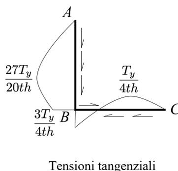
Tensione ideale secondo von Mises nel vertice B della linea media:
